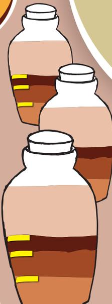
CALCULAR EL PORCENTAJE DE ARENA, LIMO Y ARCILLA MIDIENDO LA PROFUNDIDAD DE CADA MARCA. LA DIFERENCIA ENTRE LA MARCA MÁS ALTA Y LA DEL LIMO REPRESENTA LA FRACCIÓN DE ARCILLA.
